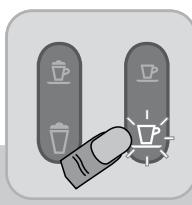
Τοποθετήστε ένα δοχείο (τουλάχιστον 600 ml) κάτω από την εκροή του καφέ, και τοποθετήστε το ακροφύσιο ζεστού νερού. 容量600ml以上の容器をそれぞれコーヒー抽出口と給湯ノズルの下にセットしてください。
