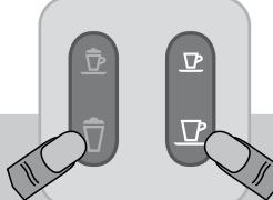
Pulse los botones Macchiato y Lungo simultáneamente durante 5 segundos.
