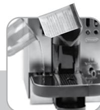
Remplir le réservoir à eau avec 500 ml d'eau et 100 ml de détartrant.
